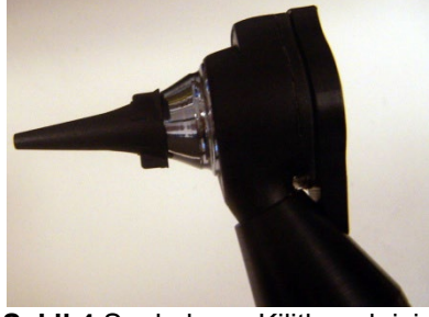
Şekil 4 Spekulumu Kilitlemek için Saat Yönünde Çevirin, Sabitlendiğini Doğrulamak için Spekulumu Yavaşça Çekin
