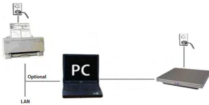
Fig. 2: Instrumentul Eclipse este alimentat de la priză și este conectat la un calculator printr-un cablu USB. Calculatorul poate fi atașat la alte dispozitive și poate să asigure în continuare siguranța pacientului.
