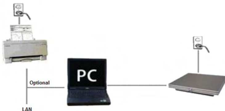
Fig. 2: O Eclipse é alimentado a partir de corrente elétrica e está conectado a um computador através de um cabo USB. O computador pode ser conectado a outros dispositivos e ainda manter a segurança do paciente.
