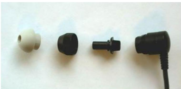
*Sonda OAE desmontada. Nota as pontas das sondas após o ano de 2010 são transparentes em vez de pretas. Assim como as pontas para ouvido de cor, por ex. verdes, azuis, vermelhas e amarelas.*
