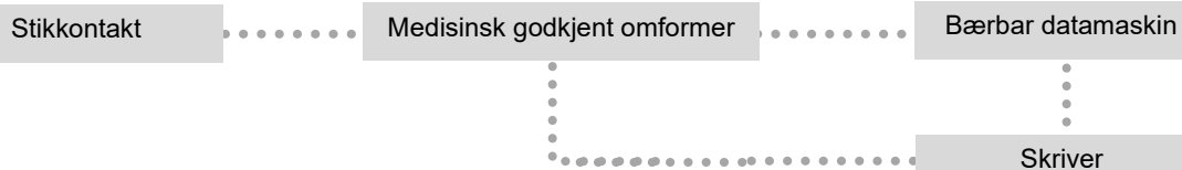
Fig. 2. Lyra koblet til en PC / bærbar PC drevet av en medisinsk godkjent transformator.
