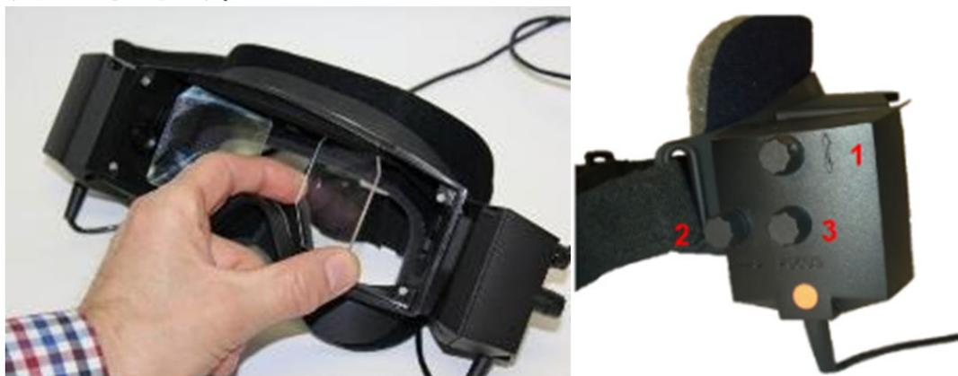
図 2.6-4 : 左 : 瞳孔間距離の調整が可能な IR ミラー 右 : 1) カメラ垂直調整用つまみ、2) カメラ水平調整用つまみ、3) カメラ焦点調整用つまみ
