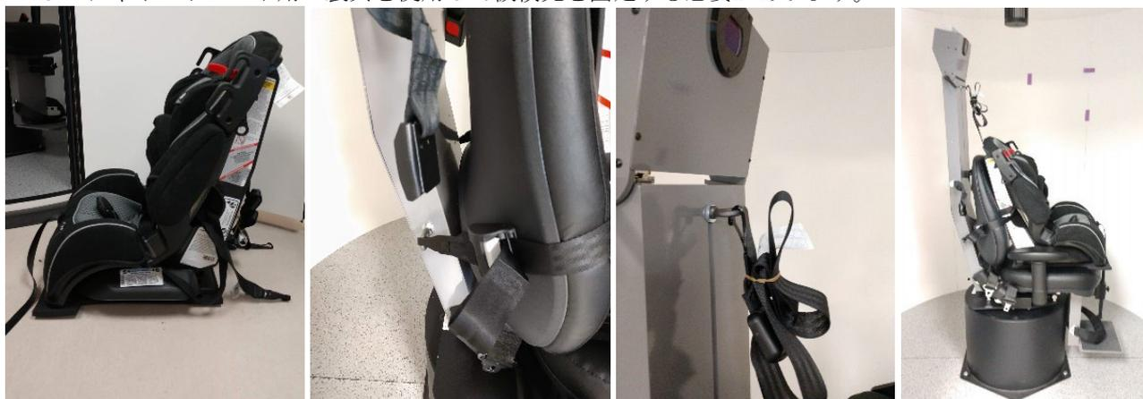
図 2.6-30 : Auto-Traverse/Comprehensive へのチャイルドシートの固定手順を示す連続画像 (左から右へ)
