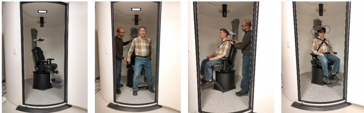
図 3.5-3 Orion/System 2000 Auto Traverse/Comprehensive への被検者の着座手順を示す連続画像 (左から右へ)
