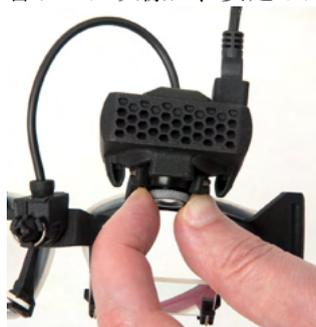
図 2.6-8 : EyeSeeCam ゴーグルのピント調整
