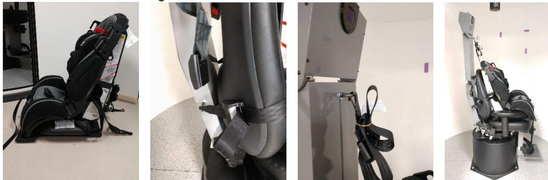
図 3.5-4 A/C へのチャイルドシートの固定手順を示す連続画像 (左から右へ)
