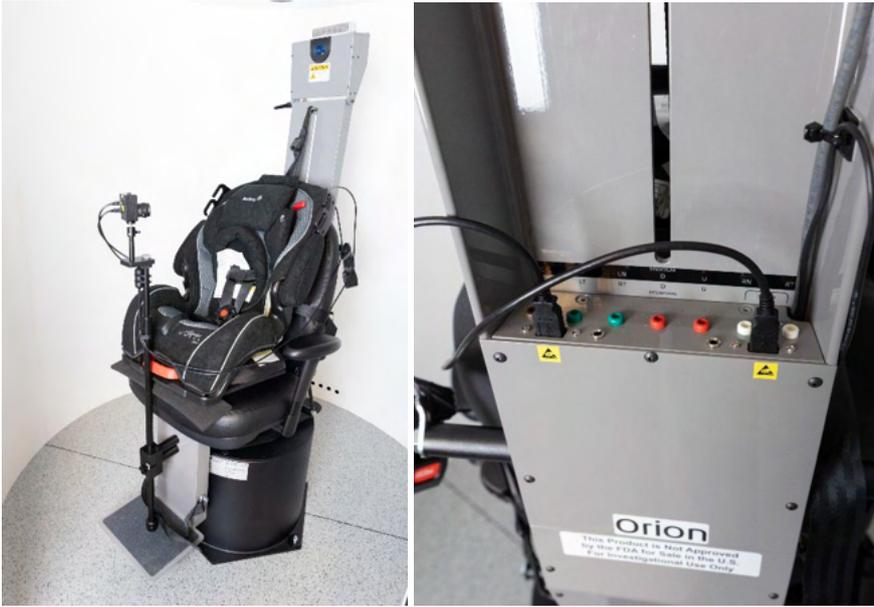
図 2.6-31 : 小児観察用カメラ Orion Auto-Traverse/Comprehensive 回転椅子の背面にある USB 接続で取付けた状態
