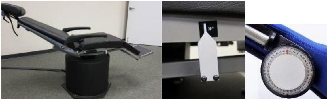
図 3.9-3 カロリック角度マーカと傾斜ダイヤルを備えたカロリック検査用リクライニング式回転椅子
