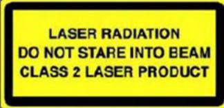
本製品には、「レーザー光線クラス 2」の構成部品（Orion Comprehensive/Auto-Traverse）が含まれています。レーザー光線を直視しないでください。 |
