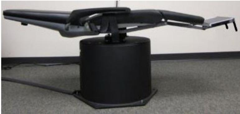
図 3.9-1 頭位変換眼振検査 (Dix-Hallpike) における Orion/System 2000 のヘッドサポートを取外して仰臥位にした状態
