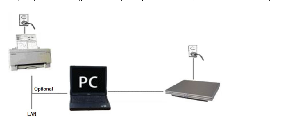
Fig. 2: Eclipse è alimentato dalla rete elettrica ed è connesso a un computer tramite un cavo USB. Il computer può essere collegato ad altri dispositivi pur continuando a preservare la sicurezza del paziente.
