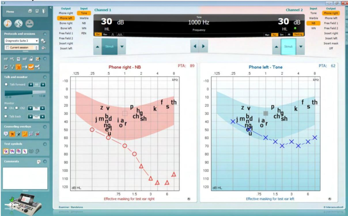
Ce mode permet à l'AD629 d'être connecté « en ligne » à l'ordinateur, et jouer le rôle d'un véritable audiomètre hybride :
