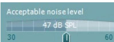
La glissière **Acceptable noise level (Niveau de bruit acceptable)** vous permet de fixer la limite de niveau de bruit acceptable à une valeur située entre +30 et +60 dB SPL. Les balayages enregistrés au-dessus de ce niveau de bruit acceptable seront considérés trop bruyants et seront rejetés.
