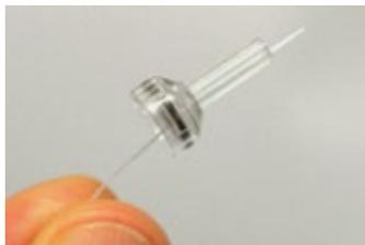
5. Tirez sur le fil de nettoyage pour le faire passer complètement dans le tube de l'embout de la sonde. Nettoyez chacun des tubes, tel que requis. Jetez le fil après usage.
