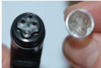
3. Pour accéder et nettoyer le plus gros canal, il est nécessaire de retirer le joint intérieur de l'embout de sonde. Cela peut être réalisé à l'aide d'une épingle fine. Remettez le joint en place après le nettoyage.
