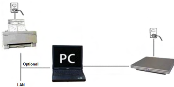
Kuva 2: Eclipse käyttää verkkovirtaa ja on yhdistetty tietokoneeseen USB-kaapelilla. Tietokone voidaan liittää muihin laitteisiin, ja potilasturvallisuus säilyy.
