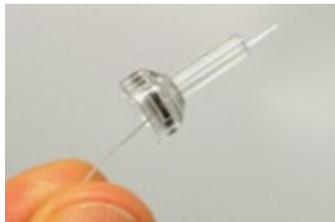
5. Tire del hilo de limpieza por completo a través del tubo de la punta de la sonda. Limpie cada uno de los tubos, según corresponda. Deseche el hilo después del uso.
