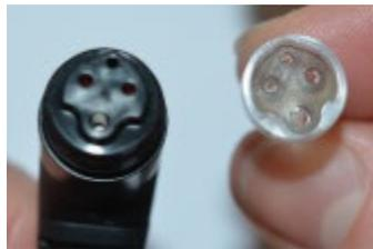
3. Para acceder y limpiar el conducto más grande es necesario retirar la junta del interior de la punta de la sonda. Puede hacer esto con un alfiler fijo. Vuelva a colocar la junta en su lugar después de la limpieza.
