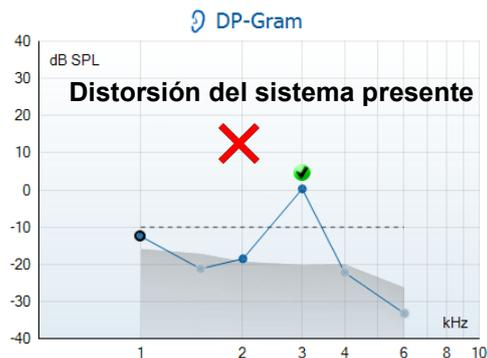
Si aparece un mensaje de error durante la prueba o si uno o más de las bandas o puntos OAE tienen una marca de verificación (lo que significa, detectado), la prueba de integridad de la sonda ha fallado. Esto podría indicar que:
