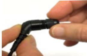
2. Retire la punta de la sonda.
