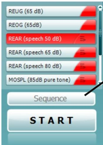
**Current Protocol** (Aktuelles Protokoll) befindet sich in der Ecke unten links. Dies markiert den aktuell ausgeführten sowie die weiteren Tests in der Batterie. Die Kontrollhäkchen verweisen darauf, dass eine Kurve vermessen wurde.
