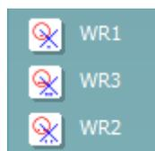
Mit **WR1**, **WR2** und **WR3** (Word Recognition; Begriffserkennung) können gemäß der Definition durch das ausgewählte Protokoll verschiedene Sprachlistenkonfigurationen ausgewählt werden. Die Bezeichnungen der Listen, die diesen Schaltflächen entsprechen, lassen sich ebenfalls in der Protokollkonfiguration individuell einstellen.
