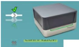
Das **Hardware indication picture** (Hardware-Abbildung) zeigt an, ob die Hardware angeschlossen ist. Der **Simulation Mode** (Simulationsmodus) wird angezeigt, wenn die Software ohne Hardware betrieben wird.
