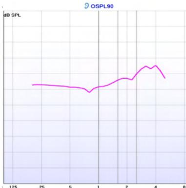
Das Diagramm (**Graph**) zeigt die gemessenen HIT-Kurven an. Die X-Achse zeigt die Frequenz an, und die Y-Achse zeigt die Ausgabe oder die Verstärkung an, je nachdem, welche Messung durchgeführt wurde.
