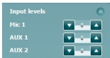
Mit den Schiebern **Input levels** (Eingangspegel) kann der Eingangspegel für den ausgewählten Eingang auf 0 VU eingestellt werden. Dadurch ist sichergestellt, dass Mic1, AUX1 und AUX2 korrekt kalibriert sind.
