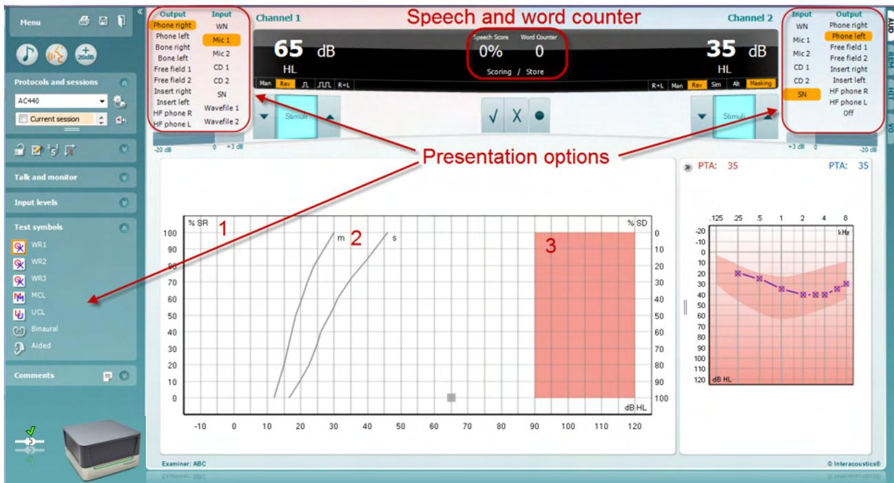
Die Einstellungen für die Darstellung im Grafikmodus unter den „Testsymbolen“ und in den Darstellungsoptionen (Ch1 und Ch2 (Kan1 und Kan2)) im oberen Bildschirmbereich zeigen Ihnen an, wo Sie die Testparameter während des Tests einstellen können.
