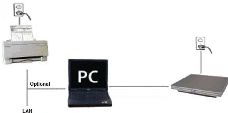
Abb. 2: Eclipse wird über den Netzstrom gespeist und ist über ein USB-Kabel mit einem Computer verbunden. Der Computer kann ohne Beeinträchtigung der Patientensicherheit mit anderen Geräten verbunden werden.
