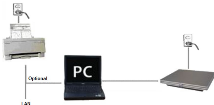
Obr. 2: Přístroj Eclipse je napájen z elektrické sítě a kabelem USB je připojen k počítači. Počítač může být připojen k dalším zařízením a stále udržovat bezpečnost pacienta.
